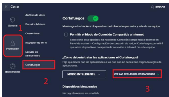
Ilustración 12: Localizando las reglas del cortafuegos (nótese el “modo inteligente” activo).
